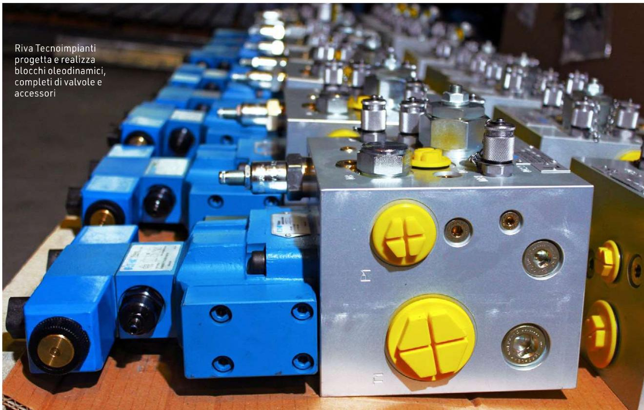
Riva Tecnoimpianti progetta e realizza blocchi oleodinamici, completi di valvole e accessori
